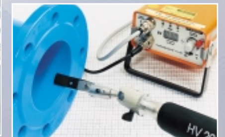
Övre bilden: Mätning av beläggningstjocklek min 250 µm
