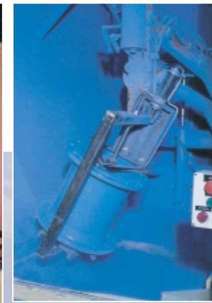
Ovan: Pulverbädd Epoxypulverbeläggning vid 200° C
